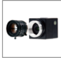
CCD 照相機和鏡頭(12mm 定焦)
