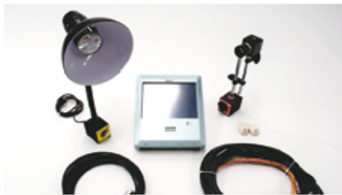
CCD 照相機和鏡頭(12mm 定焦)
